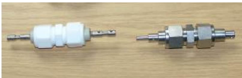
Рис. 2. Двохелектродні лабораторні макети ЕК
