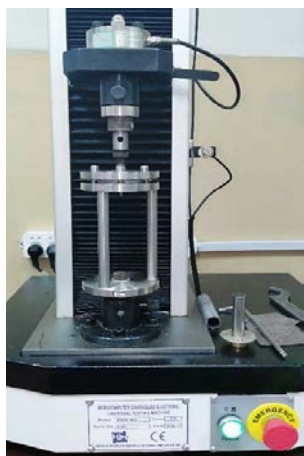
Рис. 1. Універсальна тестова машина Kao Tieh моделі KT-7010AZ
