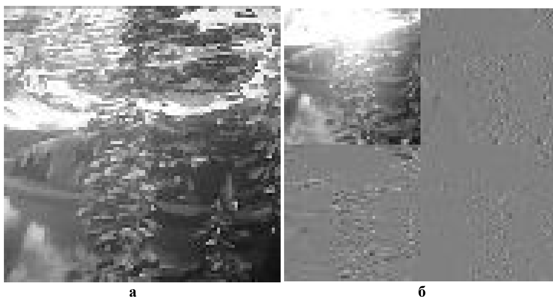
Рис. 3. Досліджувані зображення: а) – оригінальне зображення з камери модулю ESP32-CAM, б) – зображення після використання перетворення Хаара
