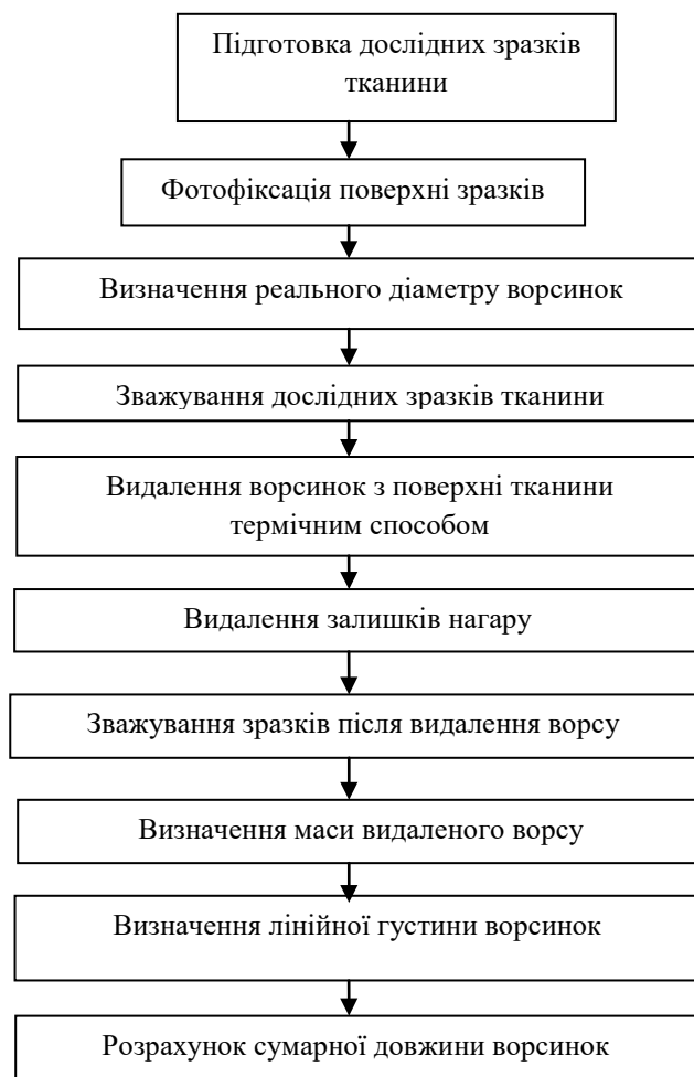
Рис.2. Етапи дослідження ворсистості тканин ваговим методом
