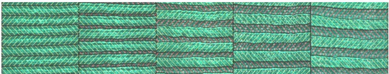
Рис. 5. Отримання даних для моделювання шляхом обробки фотозображень зразків, зроблених у процесі поетапного збільшення величини розтягуючого зусилля
