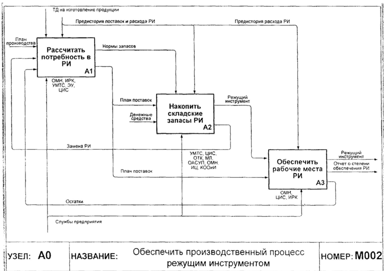
Рис. 2. SADT – DFD-модель функціональних взаємодій в процесі забезпечення виробництва різального інструменту
