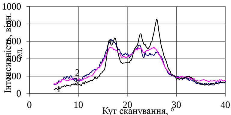
Рис.6. Дифрактограми для: 1- ПЕТФ; 2- ПЕТФ/ПК диск 95/5; 3- ПЕТФ/ПК пляш. 95/5.
