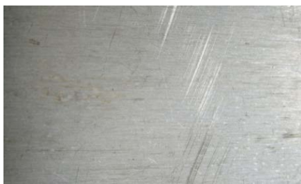
Рис. 1. Стан робочих поверхонь зразків сплаву В1341 у стані поставки до випробувань стійкості проти розшаровуючої корозії
