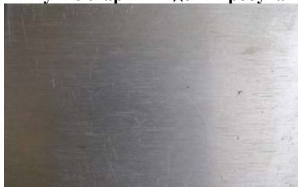
Рис. 4. Стан робочих поверхонь зразків сплаву В1341 після обробки методом «штучне старіння» після випробувань стійкості проти розшаровуючої корозії
