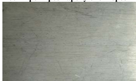
Рис. 5. Стан робочих поверхонь зразків сплаву В1341 після обробки методом «штучне старіння» і загартування до випробувань стійкості проти розшаровуючої корозії
