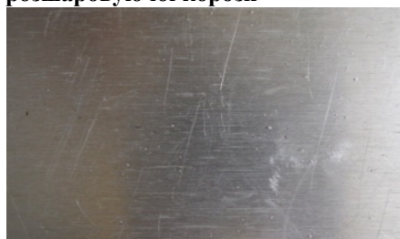
Рис. 2. Стан робочих поверхонь зразків сплаву В1341 у стані поставки після випробувань стійкості проти розшаровуючої корозії
