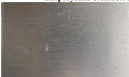
Рис. 2. Стан робочих поверхонь зразків сплаву В1341 у стані поставки після випробувань стійкості проти розшаровуючої корозії
