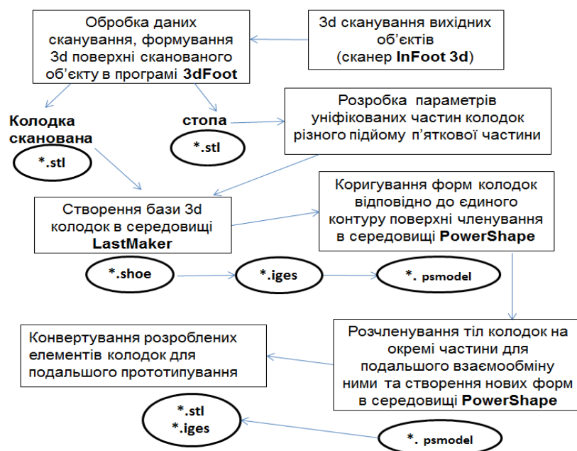
Рис. 1 Алгоритм процесу розробки форм колодок зі змінною носковою частиною в середовищі сучасних САПР
