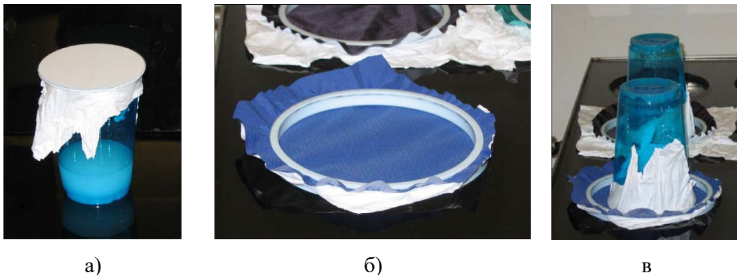
Рис. 2. Схема дослідження паропроникності ТМ «перевернутим методом сорбенту»
