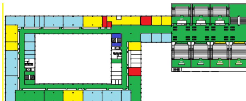
Рис. 5. Температурна карта 1 поверху корпусу №18 (при t_{\text{зовн}} = -2^{\circ}\text{C} )
