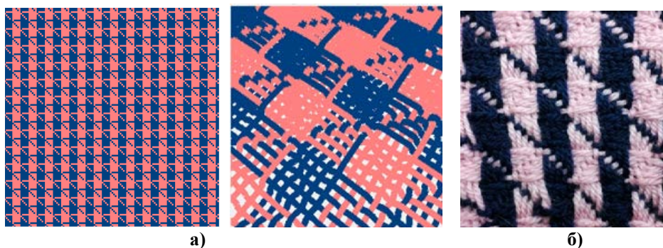
Рис. 7. Візуалізація зразка тканини 6: а) комп'ютерний дизайн; б) виготовлений зразок
