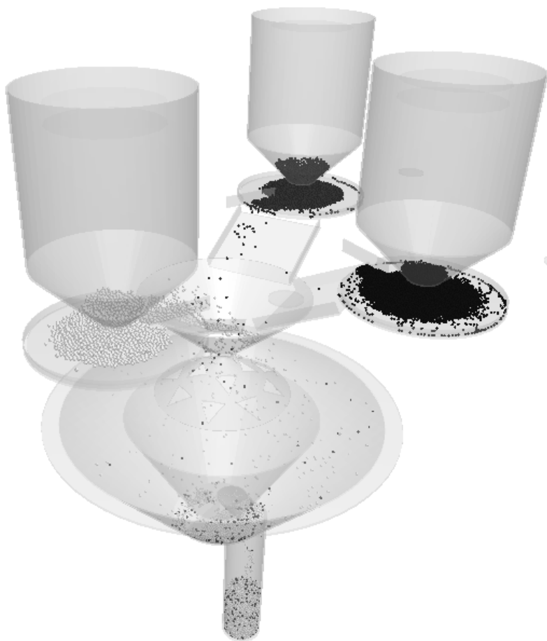
Рис. 6. Модель АЗКБД виготовлення суміші для поліетиленової плівки
