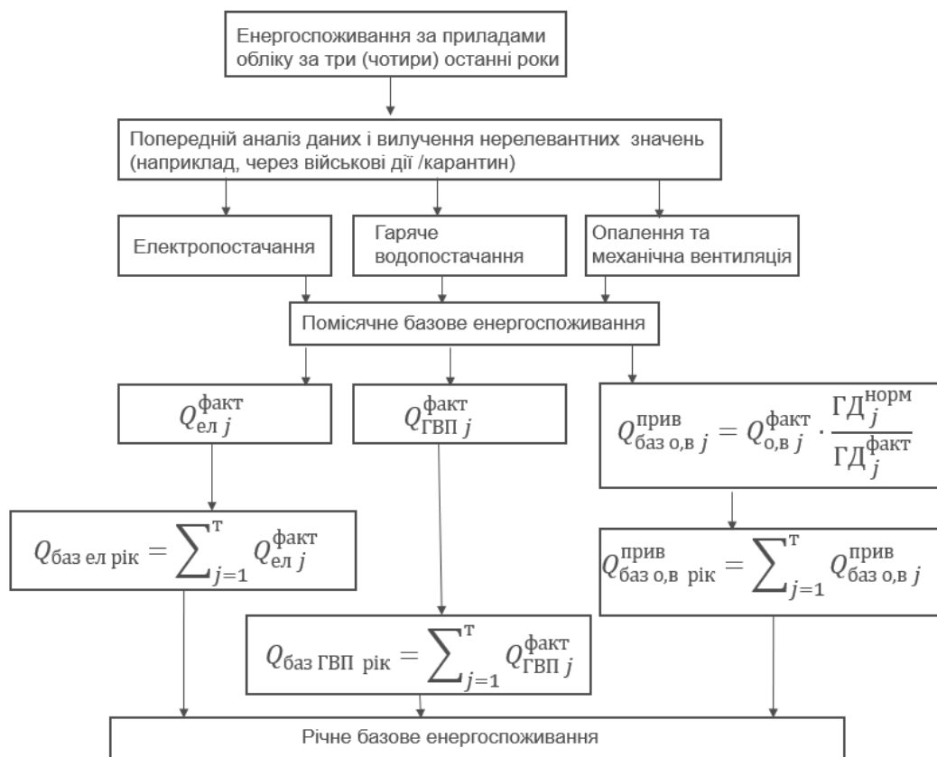
Рис. 2. Приклад послідовності обчислень при визначенні базового рівня енергоспоживання будівель
