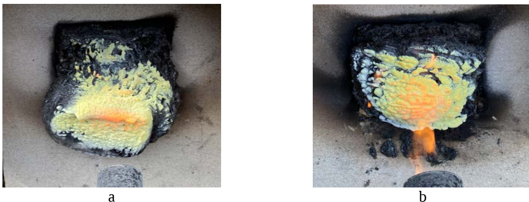
Рис. 2. Стікання інтумесцентних покриттів при спалюванні на пальнику Бунзена: а) ІС5; б) ІС6
