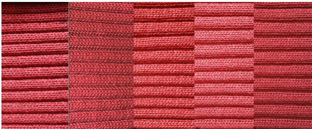
Рис. 4. Зміна геометрії поверхні трикотажу переплетення ластик 3+3 з бамбукової сировини у процесі розтягу вздовж петельного ряду
