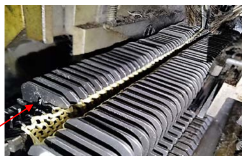
Рис. 2. Процес формування петель на плосков'язальному рукавичковому автоматі ПА-8-33: відбійною площиною слугують підборіддя платин
