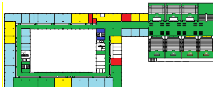
Рис. 5. Температурна карта 1 поверху корпусу №18 (при t_{\text{зовн}} = -2^{\circ}\text{C} )
