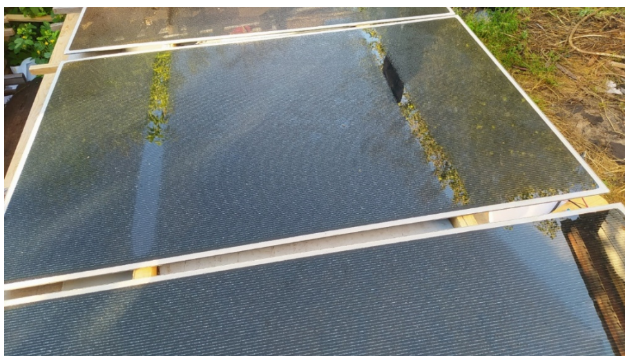
Рис. 8. Органолептичний метод виявлення місць деградації батарей, виготовлених за технологією CIGS
