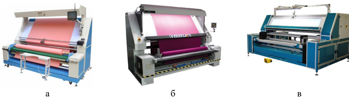
Рис. 19. Промірювально-розбракувальні машини: а – Yuli 2100CP-ED; б – Sercon DE-1; в – Rexel PP-5/AE
