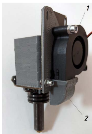
Рис. 3. Екструдер з повітряним охолодженням за допомогою вентилятора
