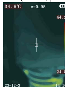
е) на зовнішній стінці бункера вище термопрокладки (точка 6)
