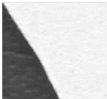
Рис. 5. Растровое изображение края шаблона, увеличенное в 65 раз при сканировании фотосканером
