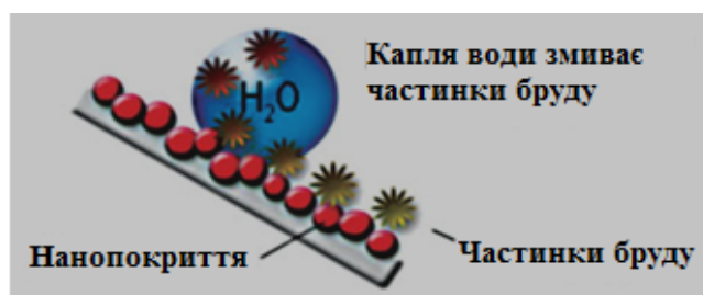
Рис. 1. Принцип самоочищення наночастинками \text{SiO}_2
