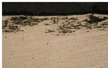
Зона сплавлення зварного з'єднання
