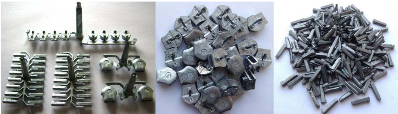
Рис. 1. Фото ливникових систем «блискавка» та відокремлених деталей
