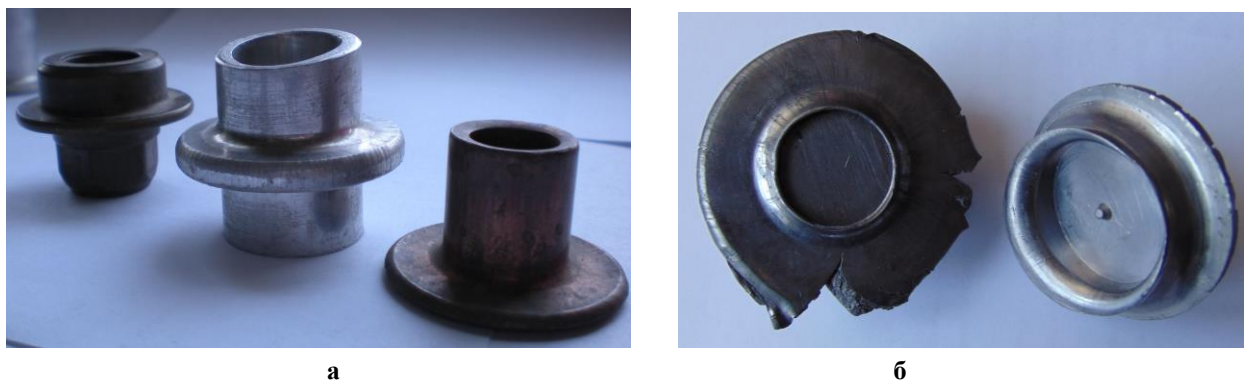
Рис.1. Деталі, отримані комбінованим радіально-поздовжнім видавлюванням: а) без дефектоутворення; б) з дефектоутворенням
