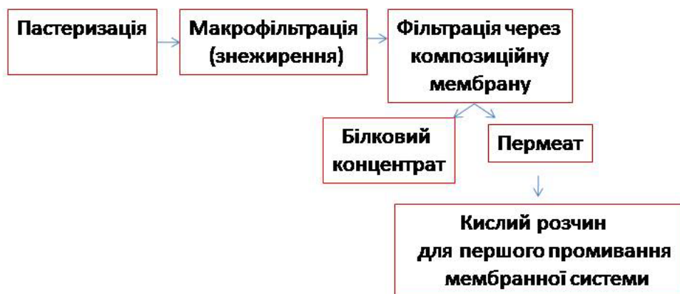
Рис. 6. Схема переробки молочної сироватки зі застосуванням композиційних мембран
