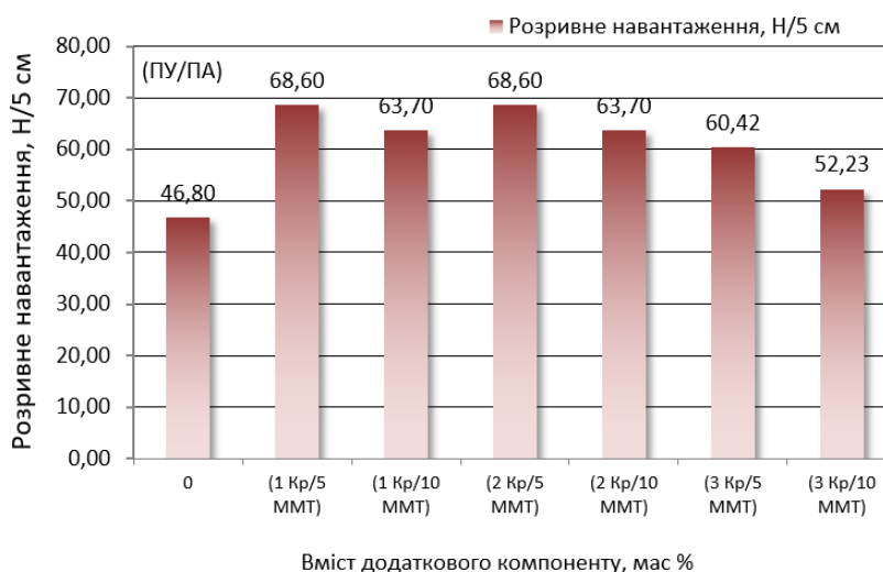
Рис. 4. Результати визначення розривного навантаження для зразків нетканих матеріалів, отриманих із волокнистих відходів ПУ/ПА-6.6
