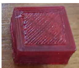
Рис. 10. Надрукований тестовий кубик: а – подрібнені частки пластику TPU; б – монопітка пластику PLA
