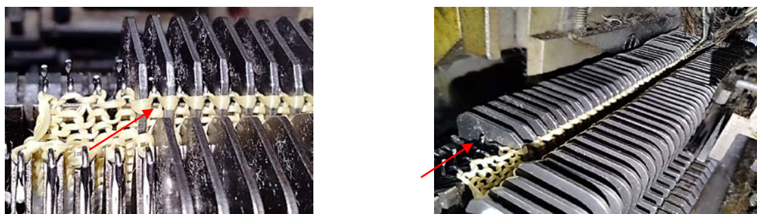
Рис. 2. Процес формування петель на плосков'язальному рукавичковому автоматі ПА-8-33: відбійною площиною слугують підборіддя платин
