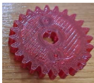
Рис. 11. Деталь «шестерня»: а – пластик PLA (філаментний екструдер); б – TPU (шнековий екструдер); в – вид деталей в торець
