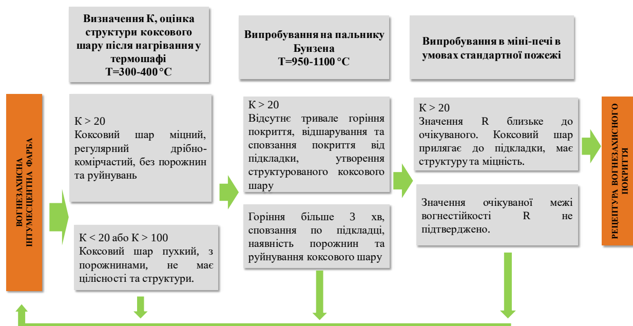
Рис. 1. Алгоритм випробувань вогнезахисної ефективності у процесі розробки рецептури інтумесцентного покриття
