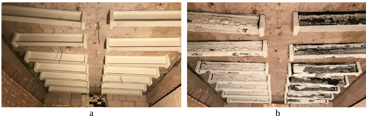
Рис. 5. Випробування двотаврових балок, захищених покриттями IC1 та IC6 з різними товщинами за DSTU B V.1.1-13:2007: а) до випробувань; б) після випробувань в умовах стандартної пожежі протягом 60 хв
