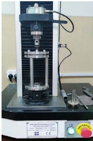
Рис. 1. Універсальна тестова машина Као Тієн моделі KT-7010AZ
